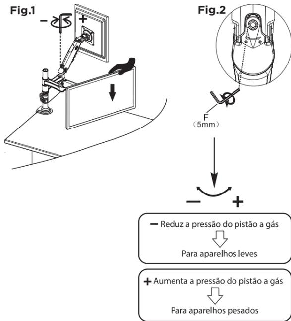
Conforme indicação (-/+) na base do braço superior do suporte, é possível ajustar a pressão do pistão a gás para deixá-lo mais "leve" ou mais "firme", de acordo com o peso do aparelho instalado. Ajuste a pressão para que o aparelho estabilize na posição desejada, sem que o pistão desça ou suba sozinho.
